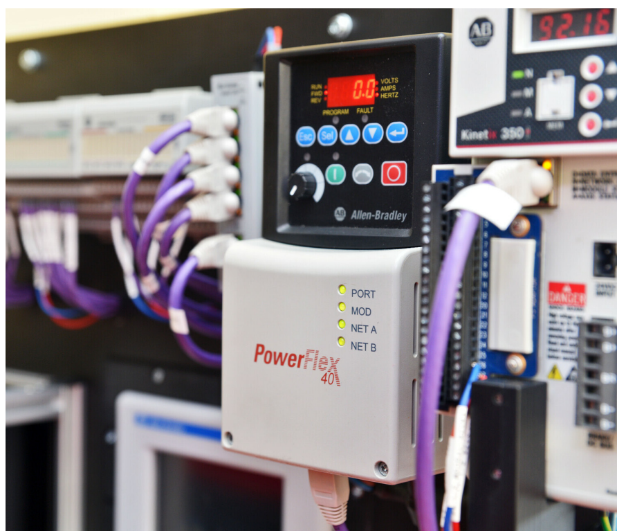
Elementy stanowiska dydaktycznego – przemiennik częstotliwości do sterowania silnikiem prądu przemiennego (PowerFlex 40) oraz jednoosiowy serwonapęd z komunikacją Ethernet/IP (Kinetix 350)
